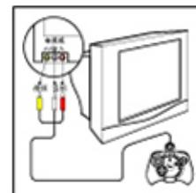
请依照左图将神游机的视音频插头分别插入对应的电视机AV输入端口。
